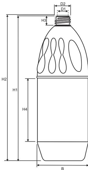
Altura do frasco (H1) sem tampa: 302,0mm
