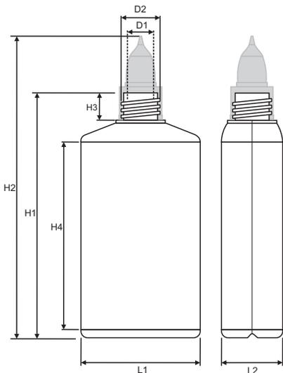
Altura do frasco (H1) sem tampa: 112,5mm
