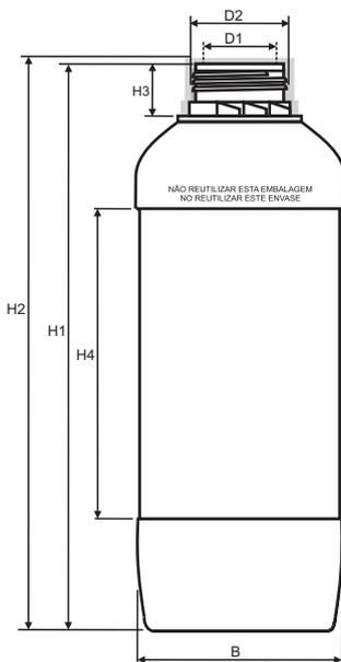
Altura do frasco (H1) sem tampa: 240,0mm
