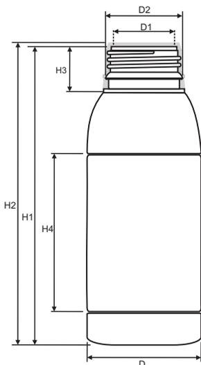
Altura do frasco (H1) sem tampa: 180,0mm
